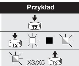
Nota: gdy procedura została wykonana prawidłowo to po krótkiej chwili "dioda radio" błyśnie 5-krotnie. Całkowite skasowanie pamięci powoduje stratę ewentualnie wykonanego oprogramowania (czas pracy, TTBUS, ...) przywracając fabryczną konfigurację.
