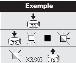
Note: Note : Pendant l'effacement, la "led radio" clignote rapidement et la fin de l'opération est signalée par 5 clignotements.
