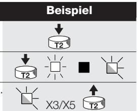
Bitte beachten: Während des Löschens blinkt die LED "Radio" schnell und das Ende des Vorgangs wird durch ein 5-maliges Blinken angezeigt. Das Löschen des ganzen Speichers modifiziert auch eventuell ausgeführte Programmierungen (Arbeitszeit, TTBUS Adresse,...), da die Steuerung auf ihre werkseitige Konfiguration zurückgebracht wird
